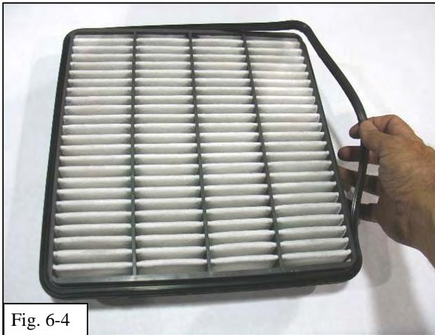
(d) Remove rubber gasket from OE air filter (Fig 6-4).
